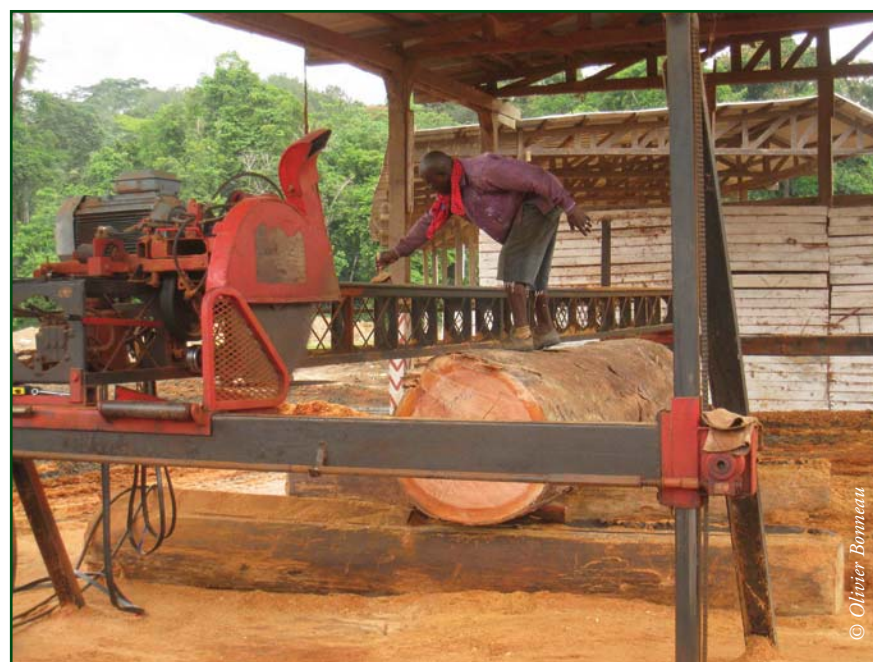
Photo 12.7 : La scie mobile « Mighty Might » permet de débiter les grumes sur site (Gabon).
