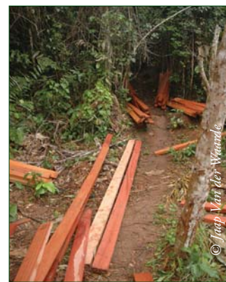
Photo 11.3 : Extraction de planches directement débitées en forêt.
