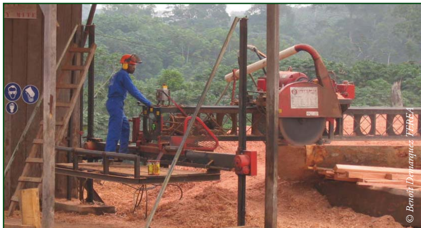
Photo 16.6 : Le sciage sur site réduit les volume de bois à transporter.
