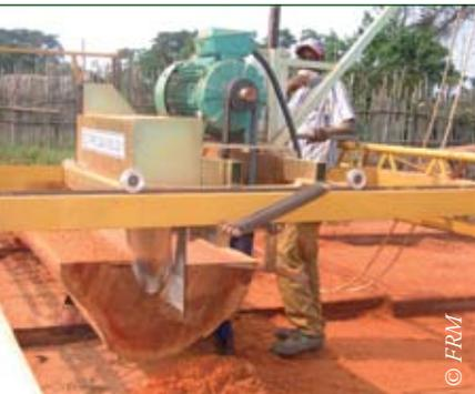
**Photo 4.6 : Les scies mobiles circulaires ont tendance à être de plus en plus utilisées**
